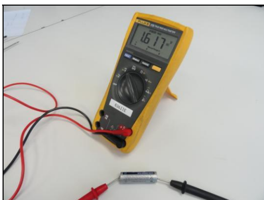
Foto 2: Ensaio de tensão máxima de circuito aberto Laboratório Labelo
